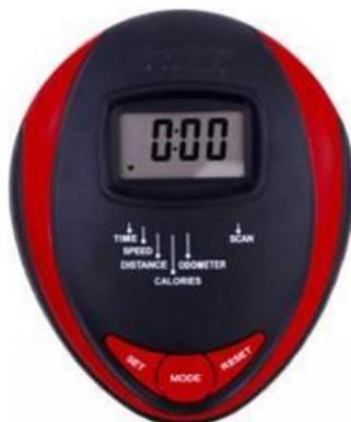
Consola se porneste automat cand detecteaza semnal de miscare. Cand va opriti din exercitiu consola se va opri automat dupa 4 minute de inactivitate.
