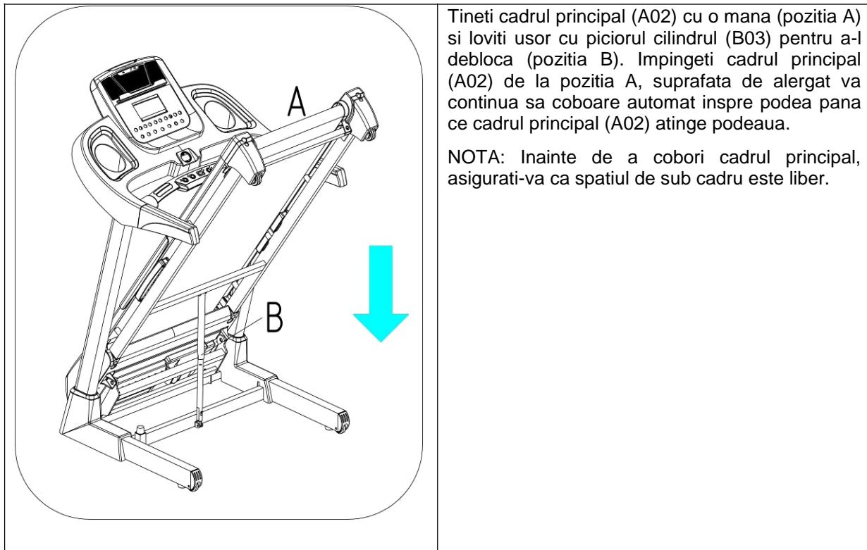
Tineti cadrul principal (A02) cu o mana (pozitia A) si loviti usor cu piciorul cilindrul (B03) pentru a-l debloca (pozitia B). Impingeti cadrul principal (A02) de la pozitia A, suprafata de alergat va continua sa coboare automat inspre podea pana ce cadrul principal (A02) atinge podeaua.
